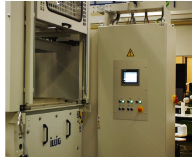
Thermoformanlage des Labors Illig UA 100 Ed
